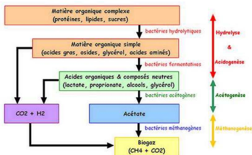
*Schéma de la production de biogaz
